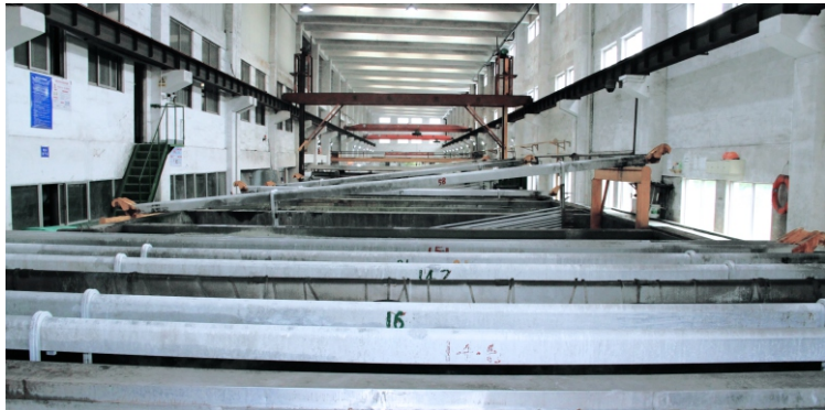
42500T/YEAR (集团总产值) 氧化、电泳 氧化生产线 Anodization Electrophoresis
